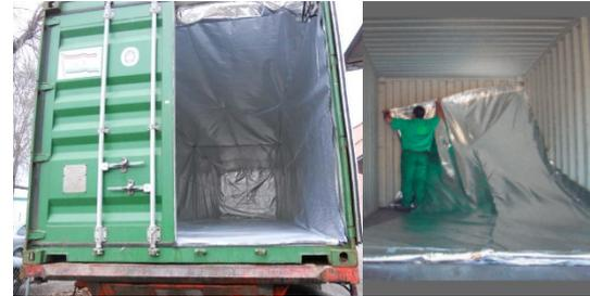
Aislante isotérmico que protege la carga durante el transporte en contenedores de bruscos cambios de temperatura protegiendo del calor por radiación (a través de la pared del contenedor) y convección (aire caliente que circula dentro del contenedor).
